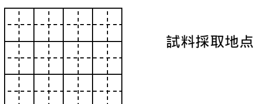
図5.4 資料等調査により汚染のおそれのある場所を想定した場合の試料採取地点の設定
