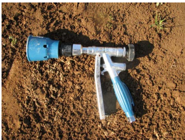
図Ⅲ-5. 飛散低減ノズル（ライトズーム LD-2 型）
