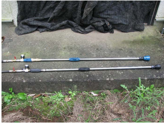
図Ⅲ-14. 飛散低減ノズル（キラナシズーム 900 型）（上）および慣行ノズル（アルミズーム α 900 型）（下）
