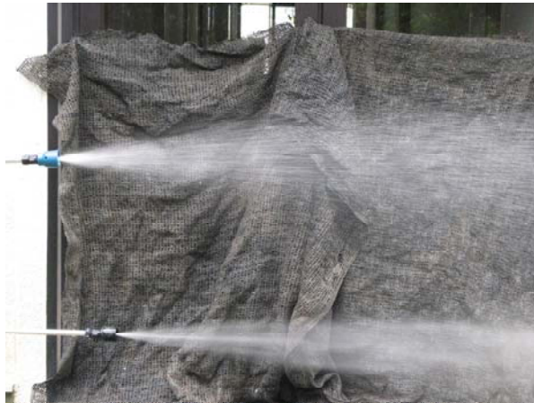
図Ⅲ-15. 飛散低減ノズル（上）および慣行ノズル（下）による噴霧
