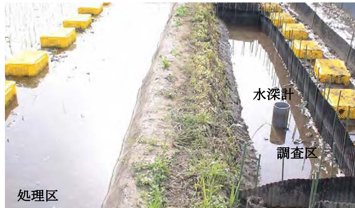
図 II-9. 土壤硬化剤を施した畦畔、農薬処理区(左側)と調査区(右側)
