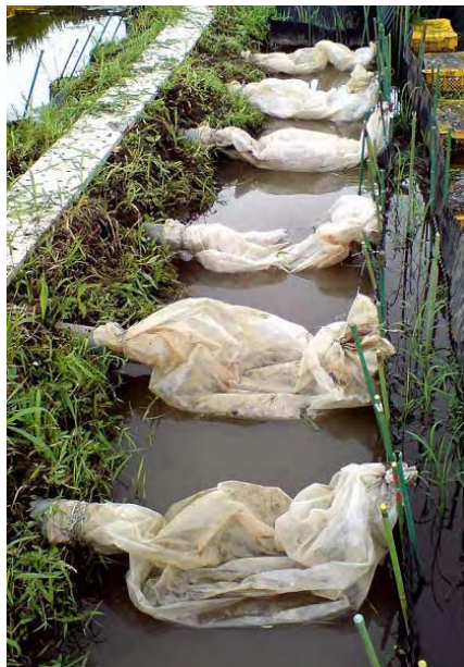
図 II-30. 漏水を捕捉するためのポリ袋
