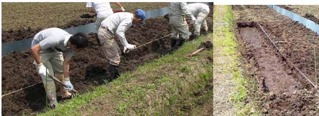
図 II-4. 調査区の造成(15~20cm 程度掘り下げているところ)(1 回目試験)
