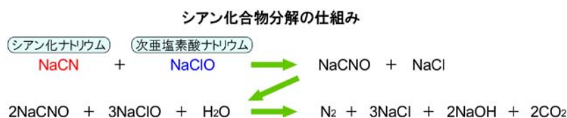
図4-2 次亜塩素酸ソーダを用いたシアン化ナトリウム分解の仕組み
