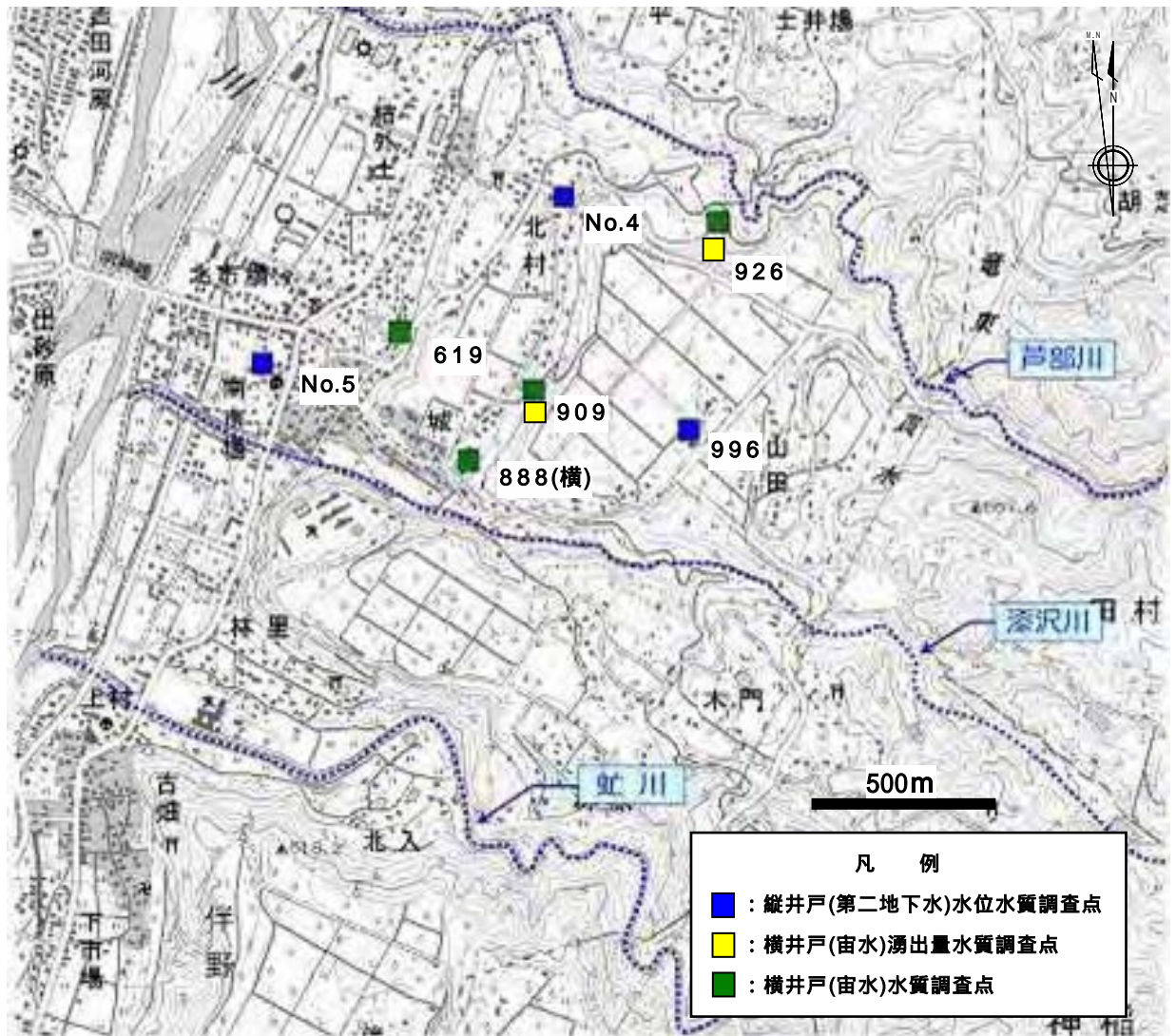
図-3.2.1 地下水モニタリング井戸の位置
