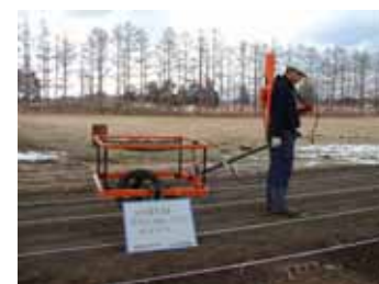
電磁探査(測定器 EM61)
