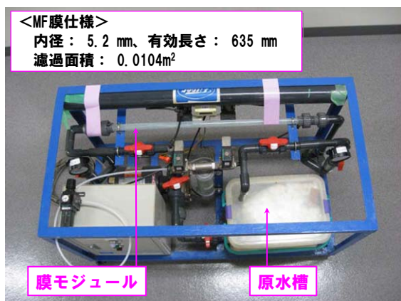
図 46 MF 膜試験機外観
