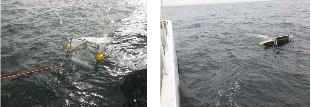
図V-2 右舷側で曳網されるニューストンネット（左）と左舷側で曳網されるマンタネット
