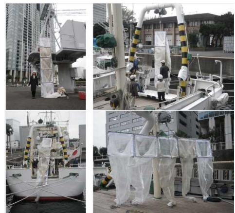
図V-1 5連ニューストーンネットの曳網イメージ図と実船での調整の様子
