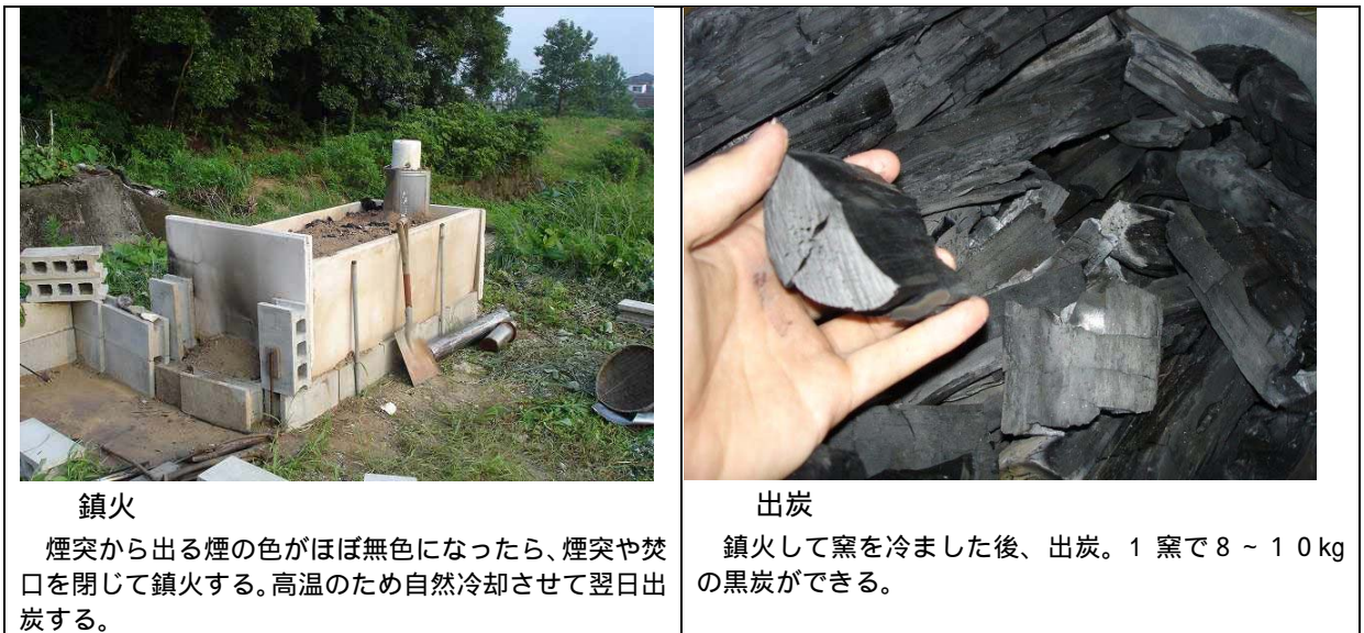
図 1.5-4 (2) 流木の炭化処理の作業の流れ
