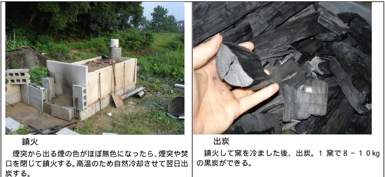
図 1.5-4 (2) 流木の炭化処理の作業の流れ
