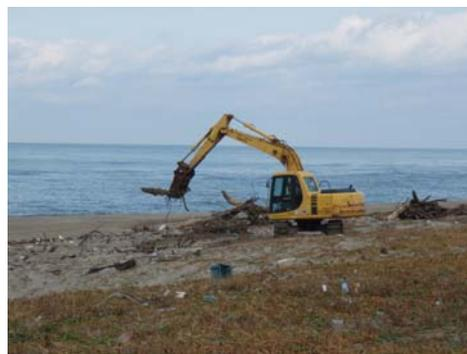
図 2.2-2 バックホウによる回収
