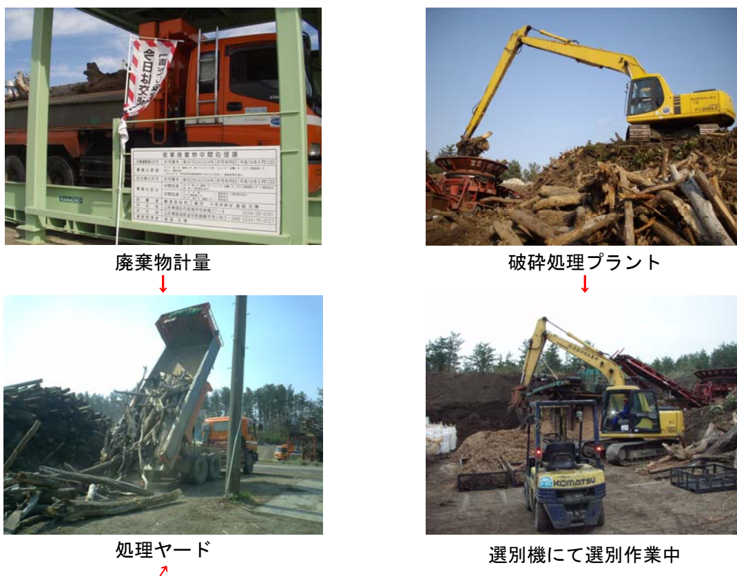
図 3.2-17 流木持込～チップ化の工程
