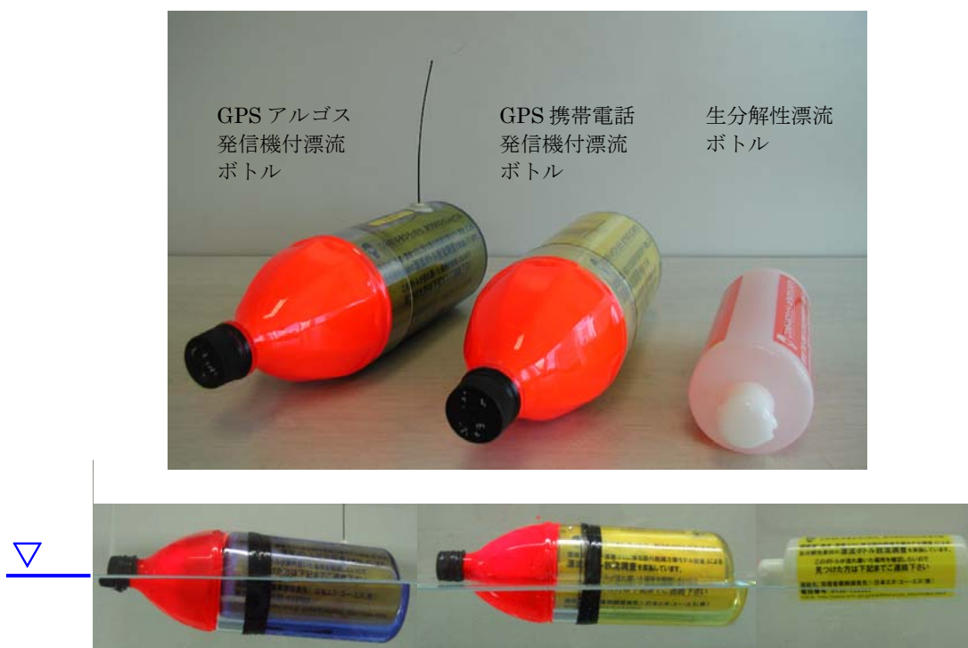
図 2 各漂流ボトルの外観と海水中での沈下状況（塩分濃度 32.5 の海水にて撮影）
