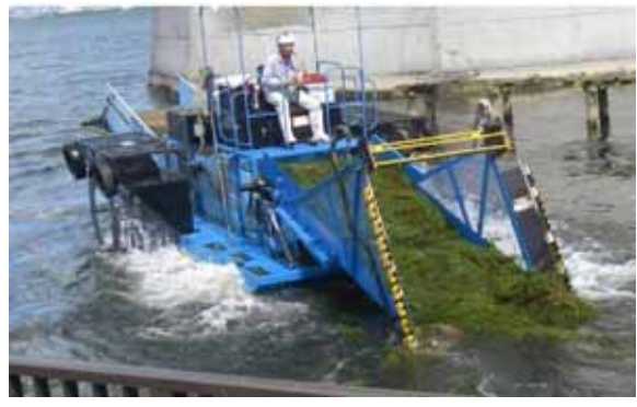
図 1.2.6-5(2) 刈取専用船による水草の表層部刈り取り
