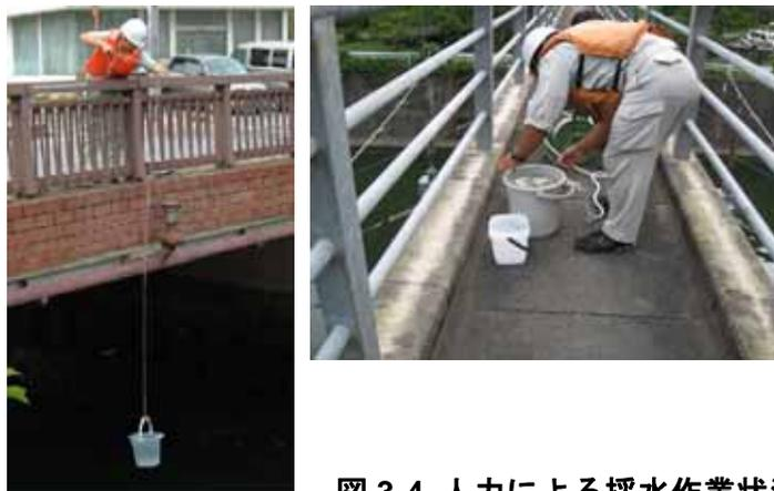
図 3-4 人力による採水作業状況の例
