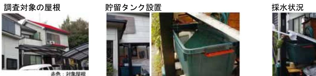
図 4-7 屋根排水負荷量調査実施状況の一例
