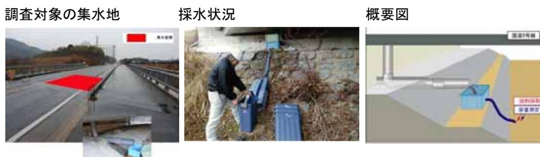
図 4-6 降雨法による道路排水負荷量調査実施状況の一例
