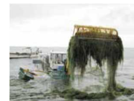
水草除去船による除去 (水草の除去等)
