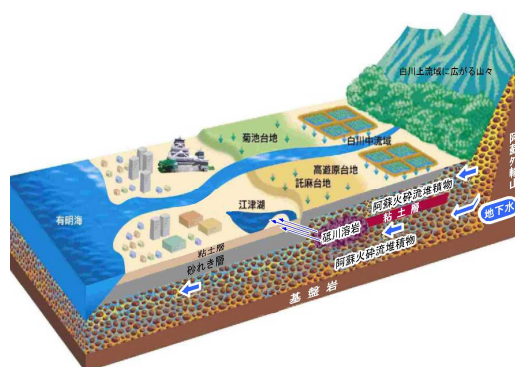
図 2 熊本地域の水理地質断面 1)
