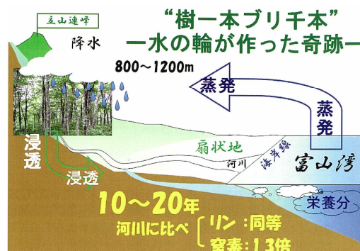
図1 富山湾東部の海底湧水循環モデル 1)
