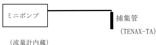
図 1 気中濃度調査 (グリホサート) の採取方法
