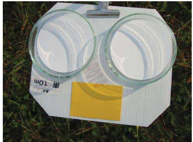
写真3 感水紙及びろ紙（ガラスシャーレ）の設置状況
