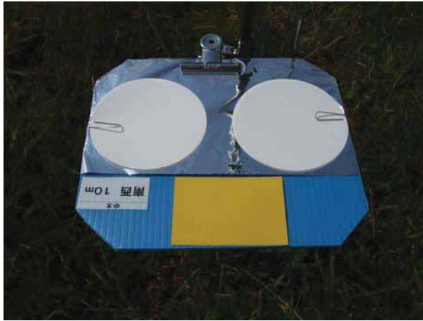
写真3 感水紙及びろ紙（ガラスシャーレ）の設置状況
