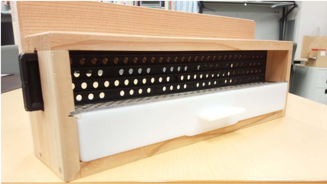
図 3-3-3-8. 花粉トラップ。巣箱の入り口に取り付ける。花粉荷をつけて帰巢したハチが上部の黒い差し込み板に空いた穴を通り抜ける際に、花粉荷が落下し、下部の引き出しに蓄積する仕掛け。
