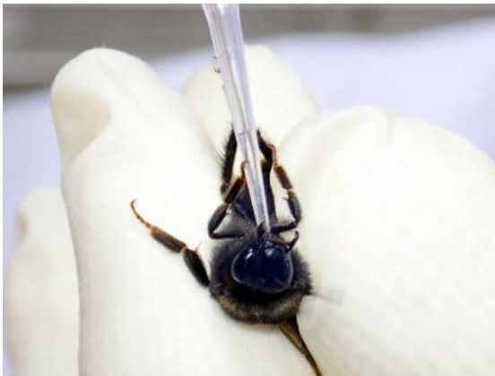
図 3-2-1-2. 急性経口毒性試験において試験液をクロマルハナバチ中舌に浸透させ投与させる様子 (左)、投与後の観察用プラスチックカップ (右)
