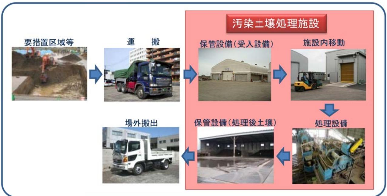
図 2.1.2-2 汚染土壌処理施設における一連の作業の例
