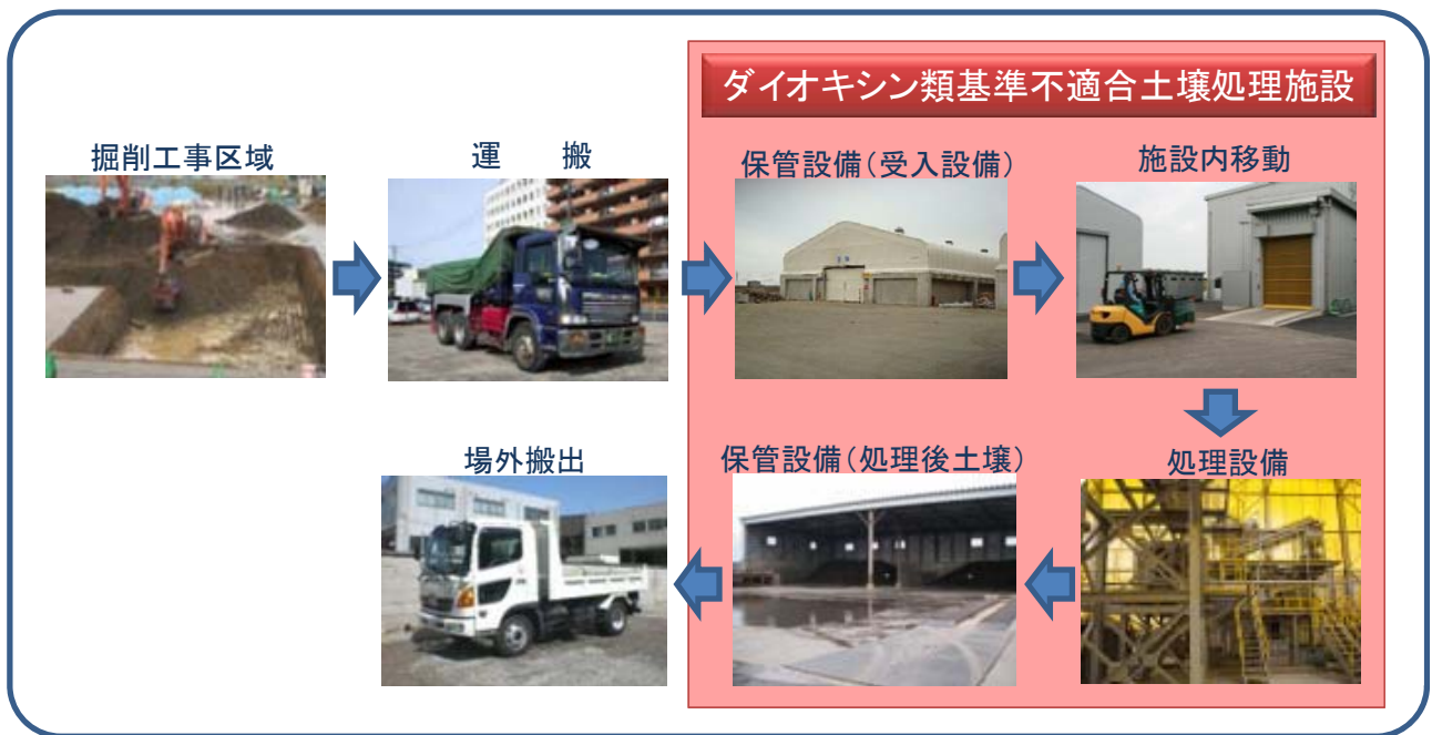
図 3.7-1 ダイオキシン類基準不適合土壌処理施設における一連の作業の例
