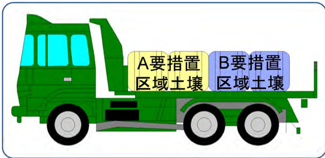
図 3.5.2-1 要措置区域等ごとに区分して運搬する方法の例（フレキシブルコンテナ）
