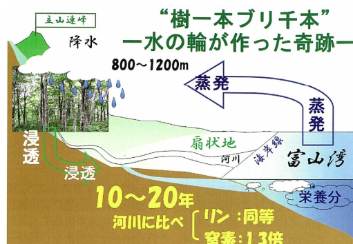
図1 富山湾東部の海底湧水循環モデル 1)
