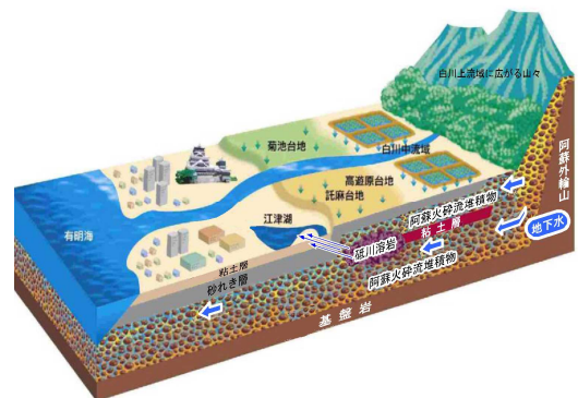
図2 熊本地域の水理地質断面 1)
