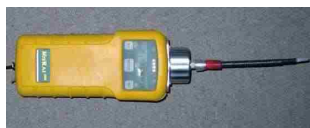
写真5-2 ガスモニター
