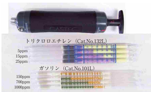
写真5-1 吸引器(上)とガス検知管
