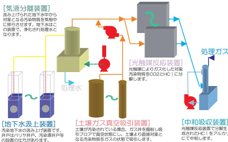
**写真 光触媒装置**
