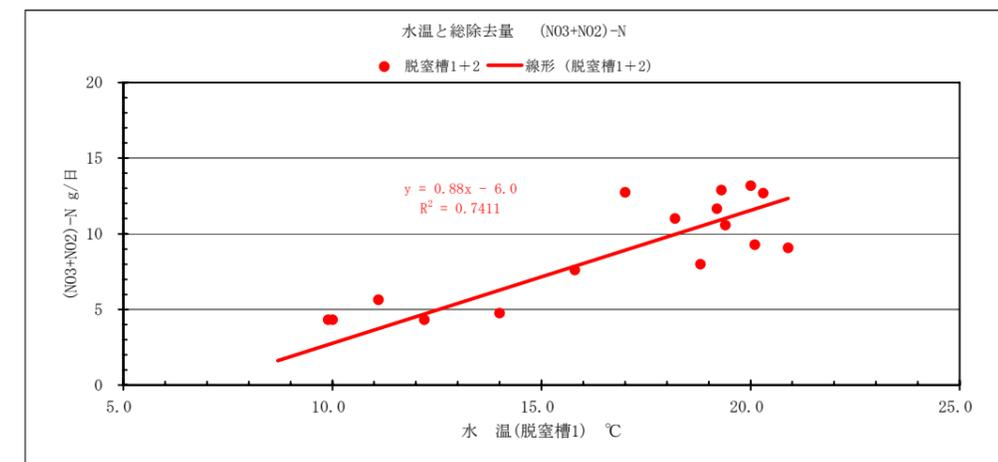
この窒素浄化装置では、前半の溶存酸素の消費を伴う溶解性有機物の産生と後半の脱窒の両者ともに槽内微生物の活性に依存しているため、処理温度の影響がより顕著なものとなりやすいと考えられる。
