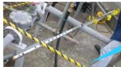
水位測定は電磁式磁歪センサーや水位計などを使用
