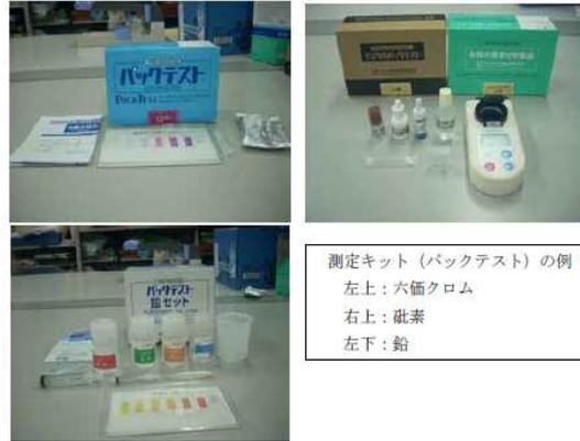
測定キット(バックテスト)の例
