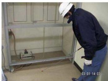
床面に見られたコンクリート面のひびをクラックスケールにて幅0.8mmと測定
