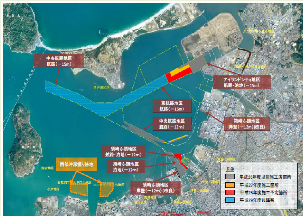
図 3-17 博多湾における浚渫工事で窪地の埋め戻し箇所
