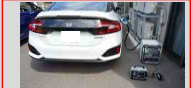
FCVからの給電：老人ホームでエアコンや小型蓄電池の充電に使用 出典：本田技研工業株式会社
