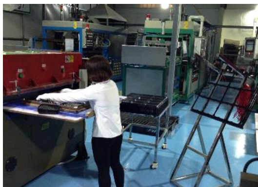
トレー加工（型抜き）の工程
