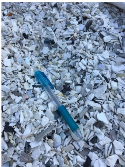
ペレット加工の材料 (家電由来 PP)
