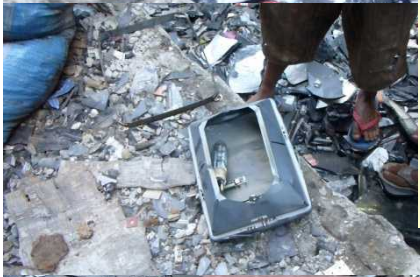
子供が素手とサンダルでCRTの破壊作業。シャドウマスクと電子銃を回収して、親に渡していた。
