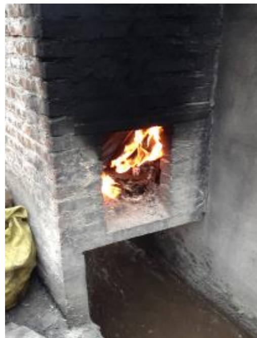
<雑物が処理される簡易焼却炉>
