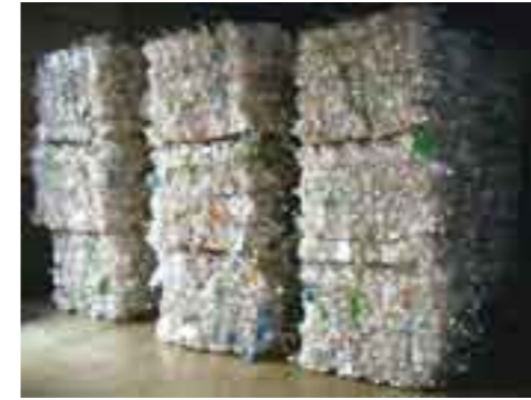
←収集後は、中継・中間処理施設において、圧縮・結束処理を行っている。(ペットボトルのペール)
