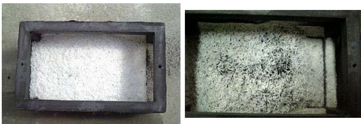
図 5-2. 1次焼成工程での空気供給量を変更した際の2次焼成後の籾殻燃焼試料の外観比較
