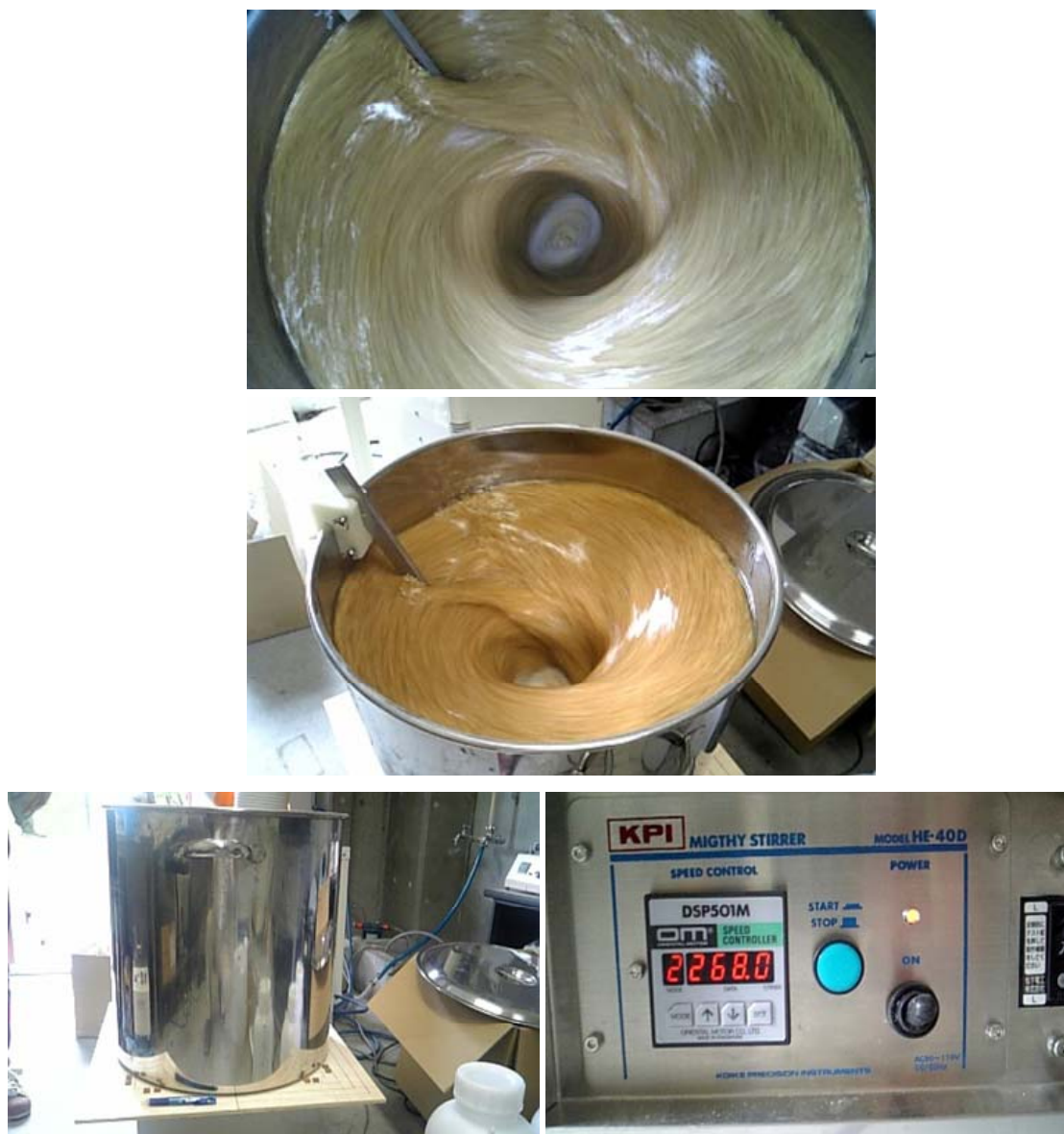
図 3-1. 電磁攪拌式大型スターラーを用いた籾殻のクエン酸洗浄処理実験
