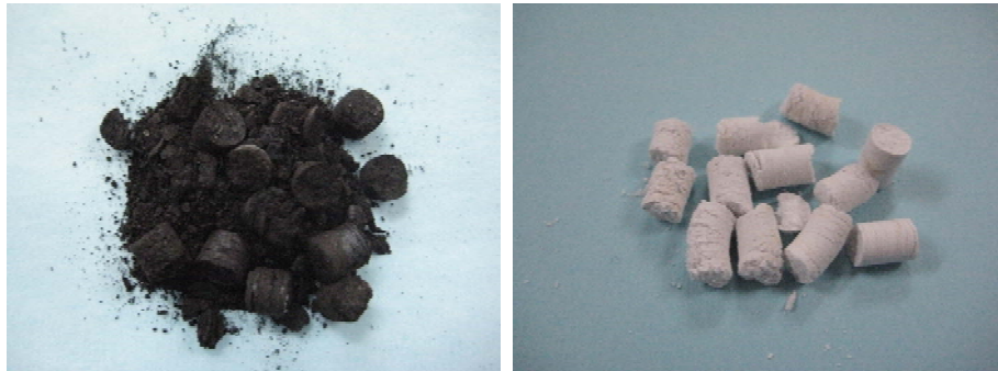
図 4-2. 籾殻固化体の燃焼後の外観 (500°C焼成(左)・800°C焼成(右))
