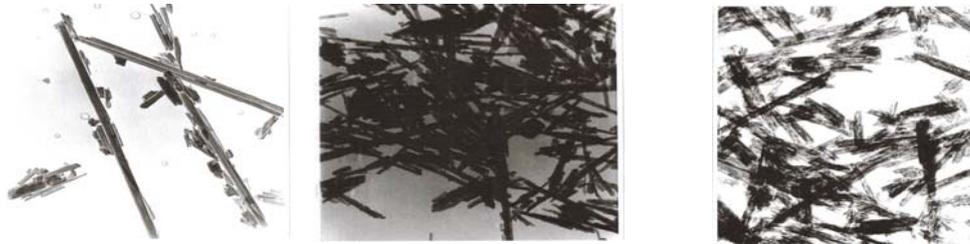
原料：蛇紋岩中のクリソタイル      水熱塩酸処理後の試料      塩酸一塩化アルミニウム水熱溶液
