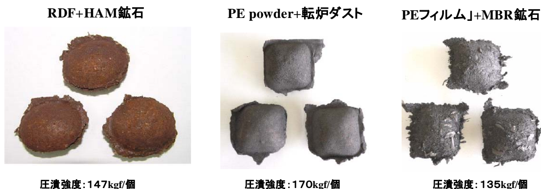
Fig. 12 熱間成型法で試作された廃棄物内装鉄鉱石ブリケットの外観と強度
