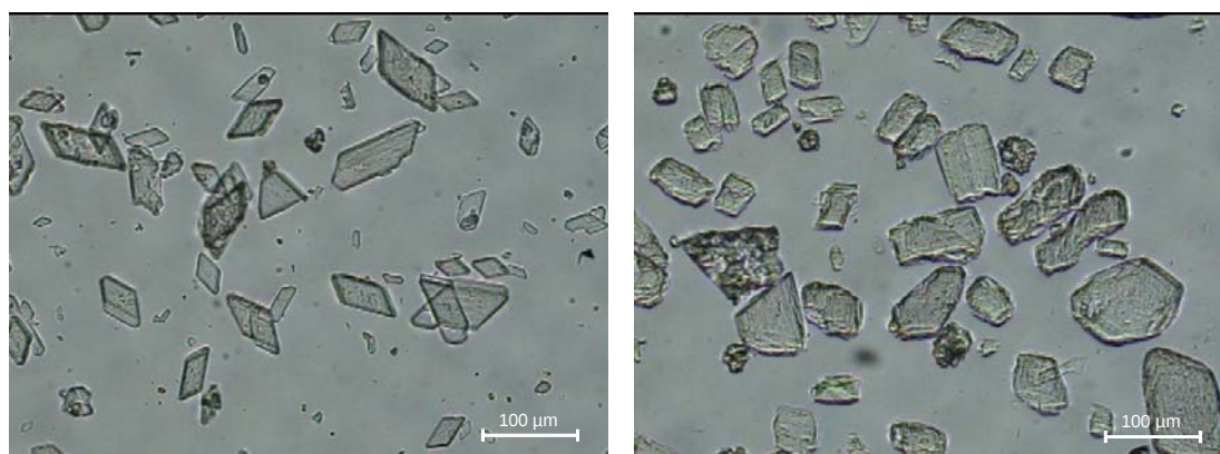
図4 溶出試験前(左)と3回目の溶出試験後(右)の化学セッコウ A 試料粒子の光学顕微鏡像
