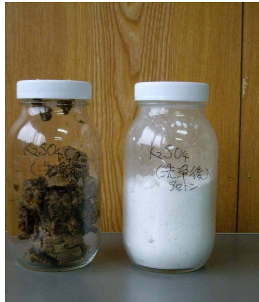
副生グリセリンからの硫酸添加後のろ過物 ( K_2SO_4 主体)
