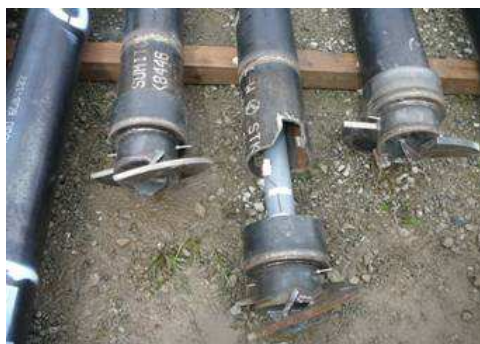
写真 3-1 先端部および鋼管ケーシング形状
