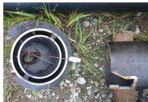
写真 3-2 先端部形状（二重管構造）
