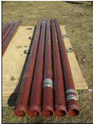
写真 3-3 ストレーナー管
