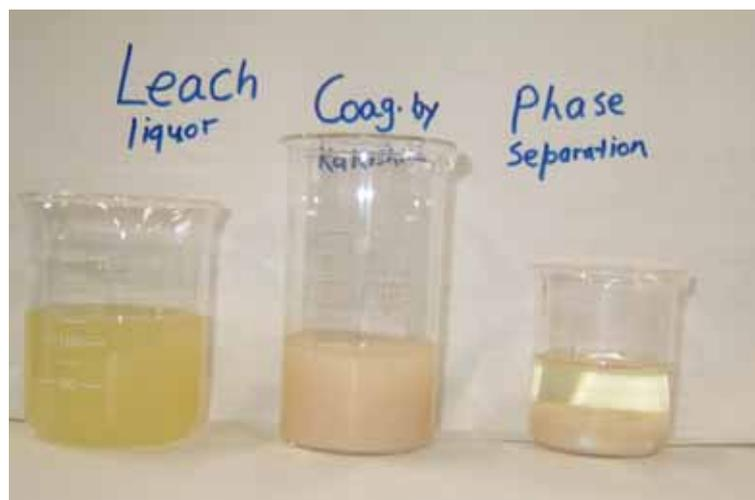
中央はこれに柿渋液を加えた直後の写真である。右は加えた後数時間後の写真である。柿渋液を加えることにより汚濁物質はフロックとして沈降し、極めて清澄な液が得られることが分かる。このような低い  $\text{pH}$  では重金属は全て清澄な液中に存在することを確認した。
