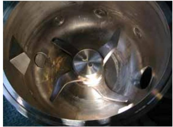
(写真2) 処理層底側面にパンチングを取り付けた
