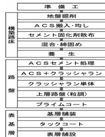
図2 実証施工のフロー
