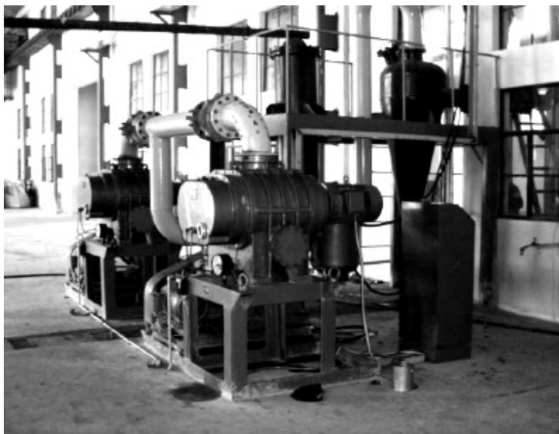
・本技術開発方式はボトルフレークをそのまま固相重合する、重合は真空バッチ方式を採用する。
