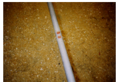
写真-3 実験土槽散水状況
